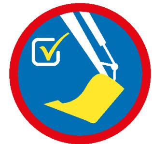
**Запрещено извлечение грунта без креплений и откосов на глубину более 1 метра**
